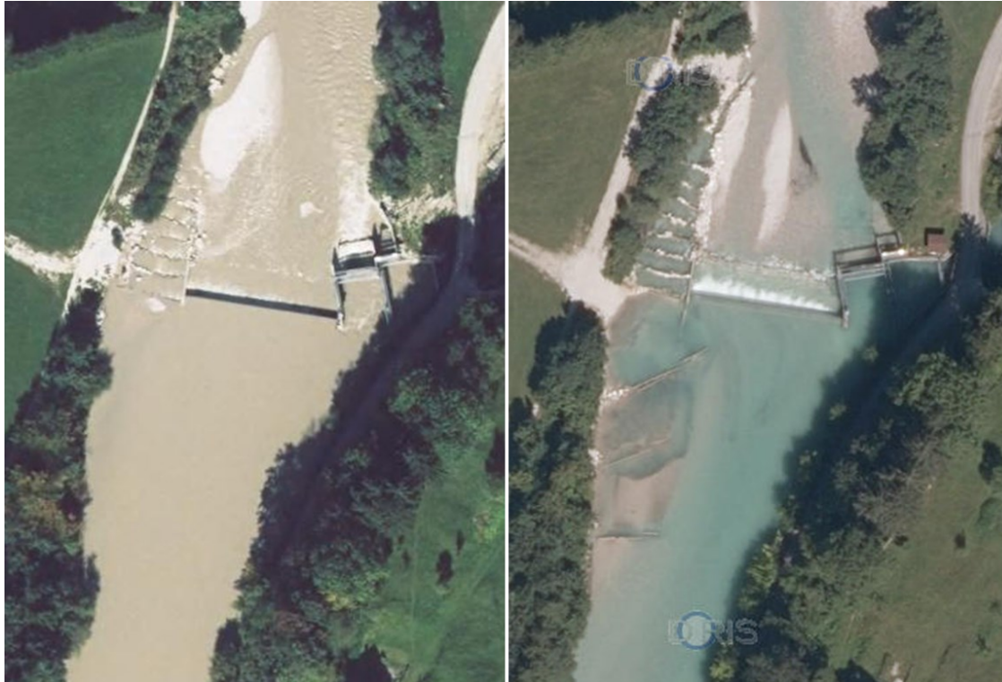
Abbildung 10: Vergleich der Geschiebesituation am KW Gangljodl – links vor Umsetzung der Maßnahmen, rechts nach Umsetzung der Maßnahmen (Quelle: DORIS, abgerufen 2022).
