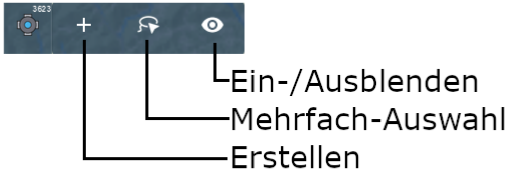
Abbildung 26: Ausgeklapptes Bau-Menü für Knotenpunkte
