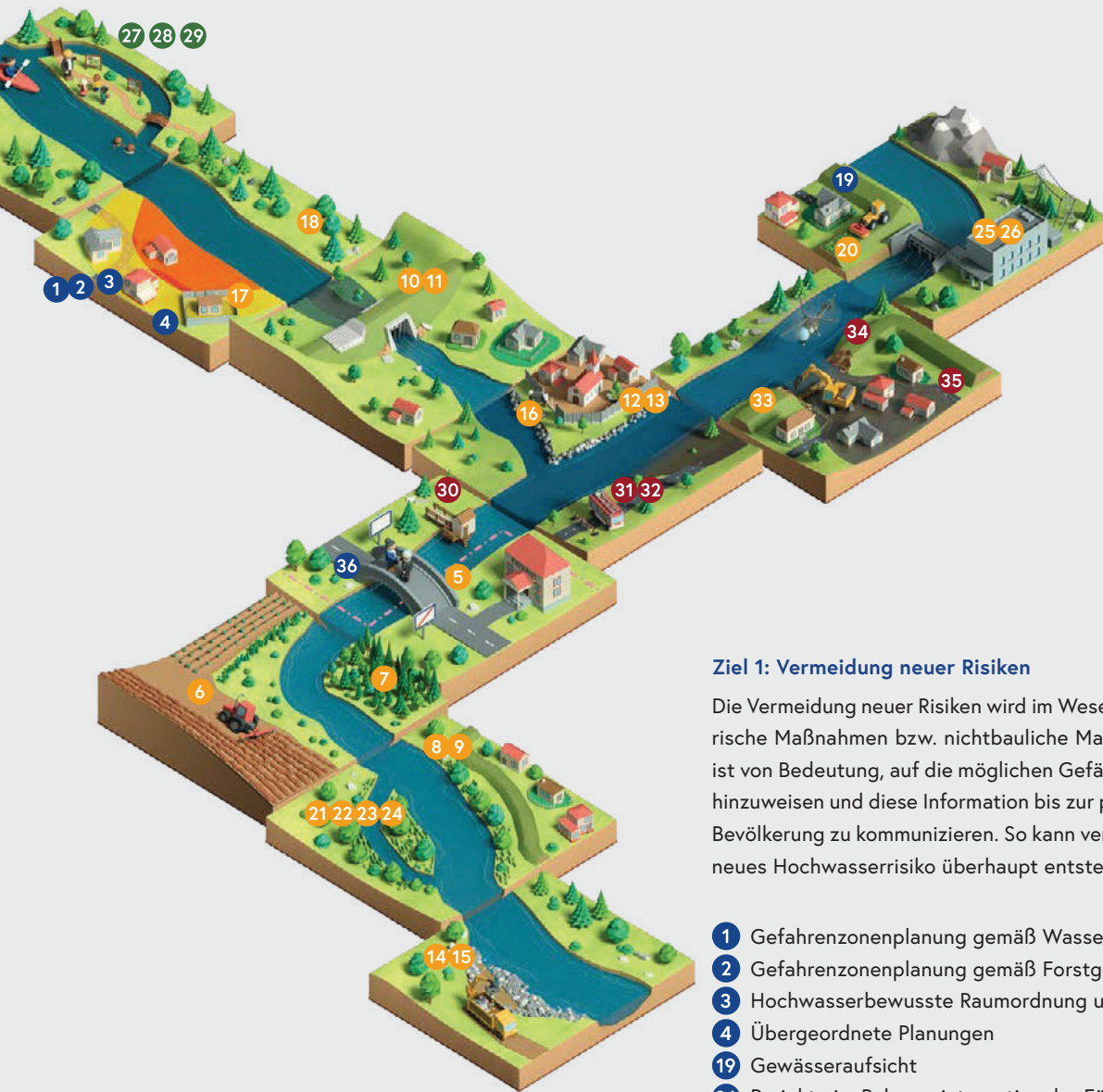
Grafik 5: Ziele und Maßnahmen eines integralen Hochwasserrisikomanagements (Quelle: BML, 2021)
