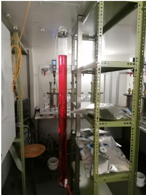
Abbildung 32 Bestimmung der Gasmenge mit einem Eudiometer, in welchem durch das Gasvolumen Flüssigkeitsvolumen verdrängt wird.
