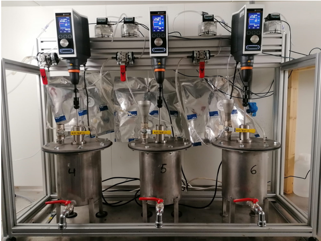
Abbildung 29 Detailfoto der kontinuierlich betriebenen Laborreaktoren, sowie der Rührwerksantriebe und Gassäcke zur Speicherung des erzeugten Biogases.
