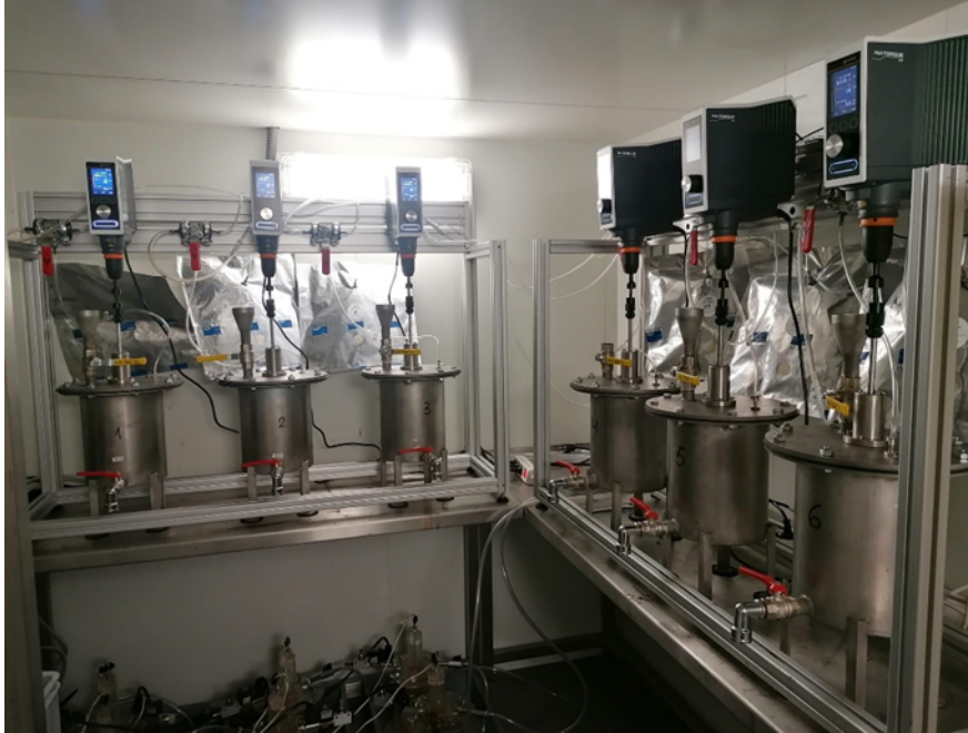
Abbildung 28 Kontinuierlich betriebene Biogasreaktoren zur Bestimmung der Biogasmenge und Gaszusammensetzung für einen Vergleich des Wendelrührers mit dem „Scaba“-Rührwerk im Labormaßstab.
