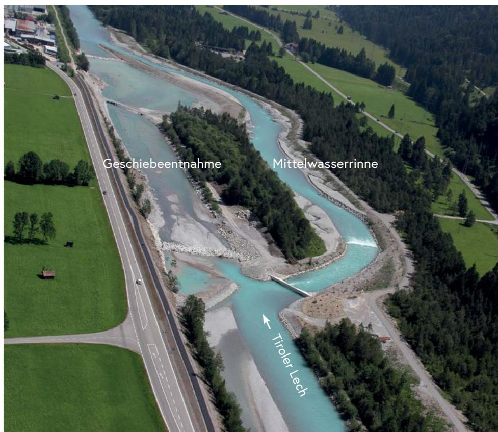
Geschiebeentnahmestelle Höfen-Hornberg: Parallel zum Geschiebe-ablagerungsbecken wurde eine neue Mittelwasserrinne angelegt. Diese sorgt für den weiterhin notwendigen aber reduzierten Geschiebetransport in die Unterliegerstrecke.
