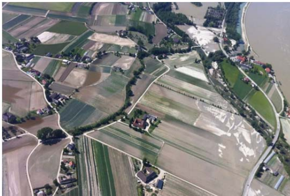
Abbildung 7-7: Eferdinger Becken: Feinsedimentablagerungen Juni 2013 (Verbund, 2014) [F004]
