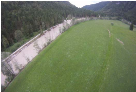
Abbildung 7-23: Links: Uferanrisse und teilweise zerstörter Wirtschaftsweg am linken Ufer (Quelle: Amt der Tiroler Landesregierung); Rechts: Feinsedimentablagerungen im linken Vorland bei FKM 9.00 (Quelle: Amt der Tiroler Landesregierung)
