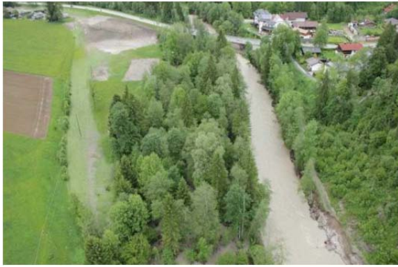
Abbildung 7-25: Links: Sedimentablagerungen flussauf der Neuwirtbrücke (Quelle: Amt der Tiroler Landesregierung); Rechts: Feinsedimentablagerungen im linken Vorland flussauf der Neuwirtbrücke (Quelle: Amt der Tiroler Landesregierung)
