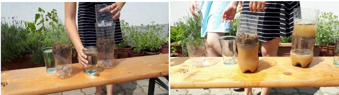
Abbildung 9: Aggregatstabilität – Flaschentest (Fotos: Lorenz Mayr, Verein Boden.Leben)
