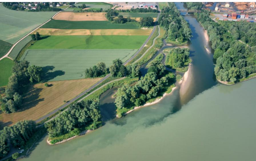
Die neu errichtete Fischwanderhilfe beim Donau-Kraftwerk Melk ermöglicht den Austausch von Fischen zwischen der Fließstrecke im Bereich der Wachau und dem Ybbsfluss. Das wurde auch beim ökologischen Monitoring nachgewiesen.
