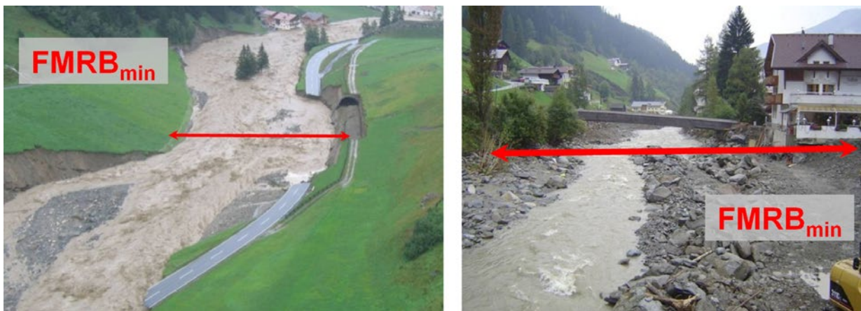
Abbildung 10: Darstellung des benötigten minimalen Flussmorphologischen Raumbedarfs (FMRB min ) beim Hochwasser 2005 an der Trisanna. (© ASI, BOKU-IWHW)
