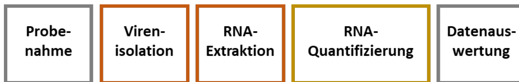
Abbildung 5: Gliederung des analytischen Prozesses zur quantitativen Bestimmung von SARS-CoV-2 in Abwasserproben.
